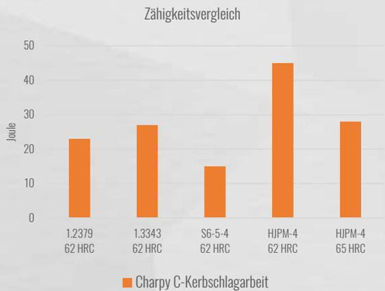
Charpy-C-notch-Probe mit einem Kerbradius von 12,7mm
